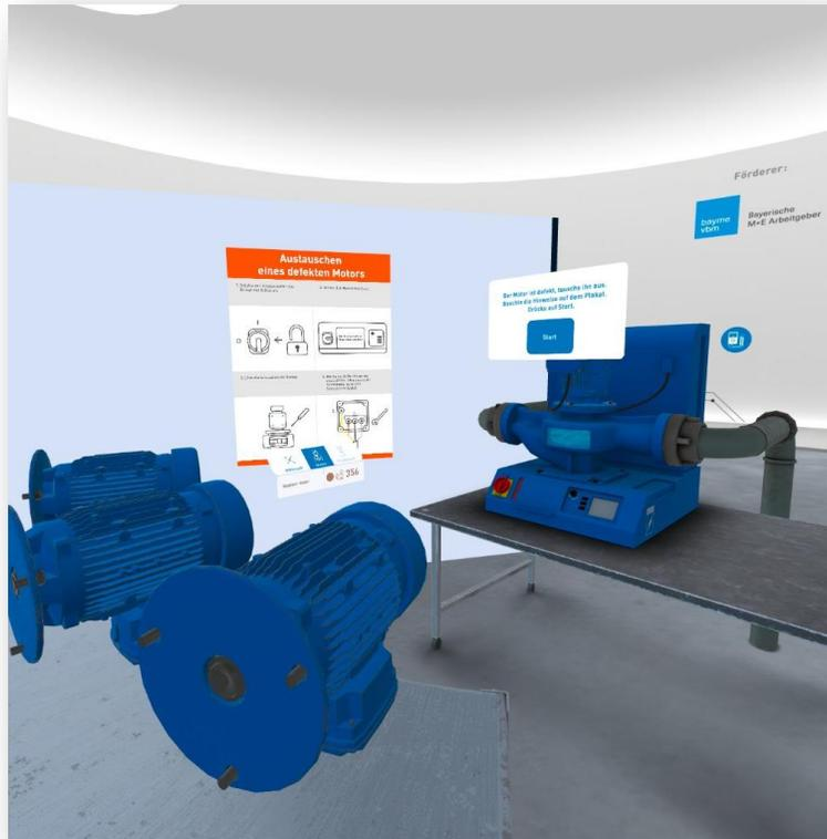
Ausbau des defekten Motors, Auswahl und korrekter Einbau des neuen Motors
